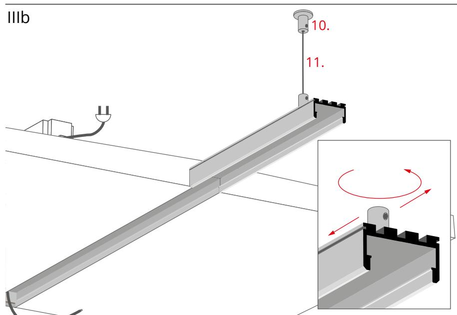
Połącz zawieszkę sufitową (10) i zawieszkę w profilu linką (11).
