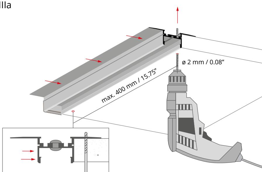
Przyłącz profil do krawędzi płyty gipsowo-kartowej i wywierć otwory, przechodzące przez płytę i kołnierz profilu.
