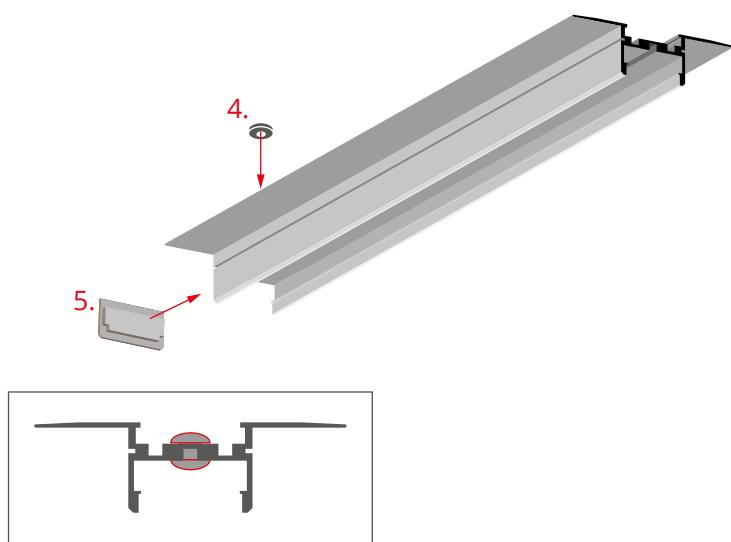
Zamontuj zaślepkę (5) w profilu i dławnicę (4) w nawierconym otworze.
