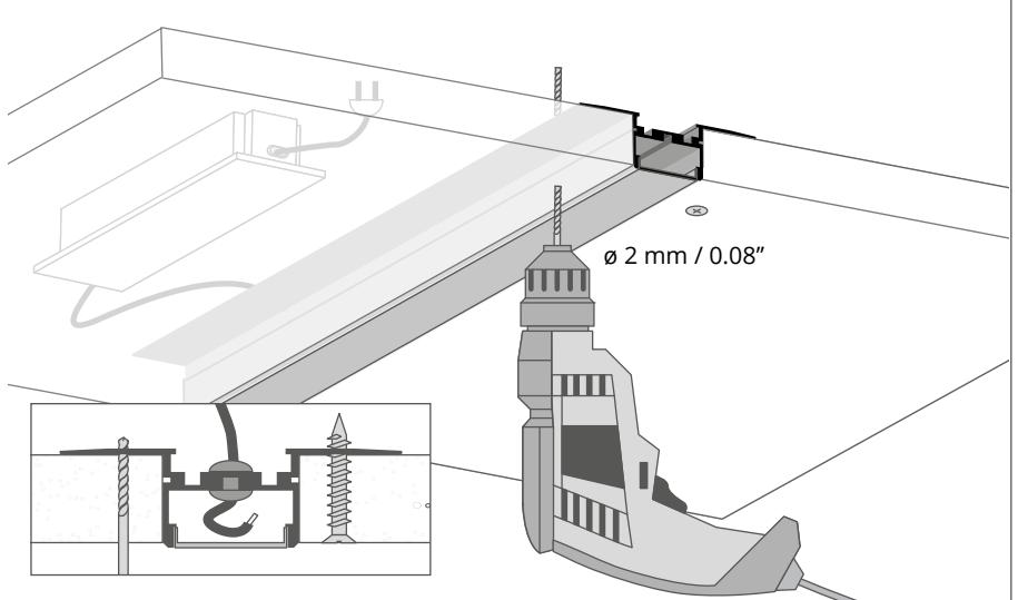
Wywierć otwory w dokładanej płycie
