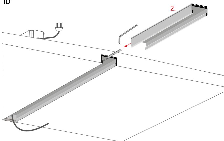
Nałożyć profil GIZA-LL (2) kanałem wewnętrznym na wystającą część łącznika. Następnie dokręcić wkręty łącznika kluczem ampulowym.
