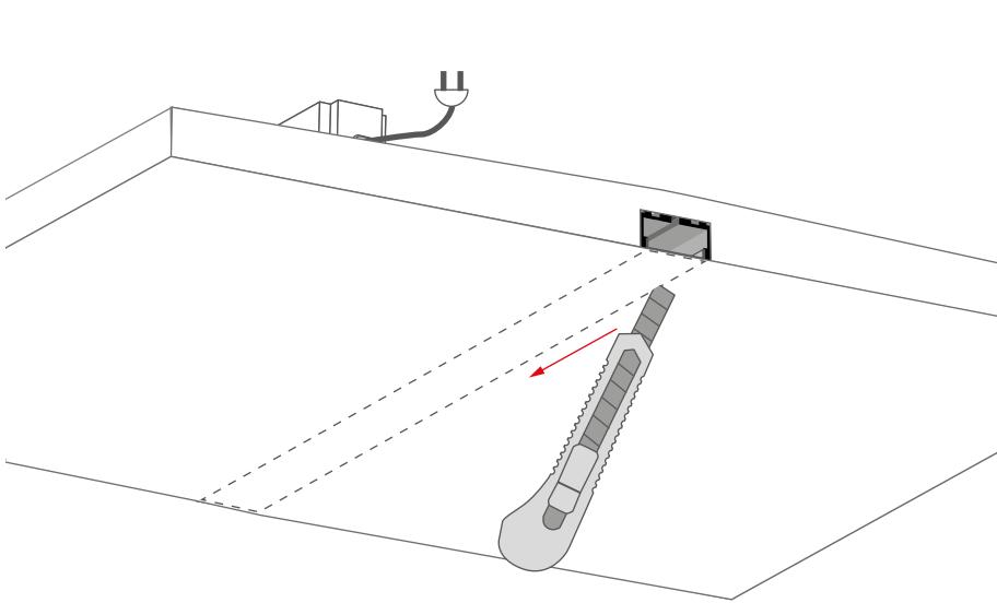
Natnij warstwy farby i gładzi na styku aluminiowej krawędzi profilu i wkładki ochronnej.
