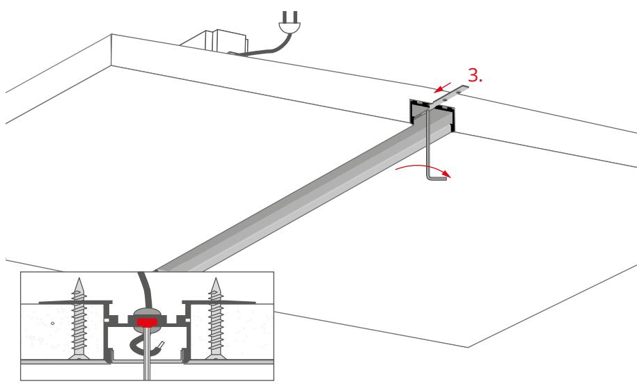
Wprowadź łącznik (3) w kanał wewnętrzny profilu i dokręć wkręty blokujące kluczem ampulowym.
