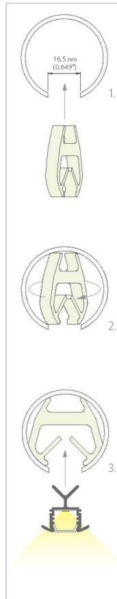
PL Demontaż opraw należy wykonać stosując dźwignię i podważając oprawę za kolnierze po obu stronach bezpośrednio przy zatrzaskach. Demontaż opraw może spowodować ich odkształcenie. W zastosowaniach zewnętrznych w oprawach POR należy stosować diody wodoodporne lub oprawy uszczelnione. W poręczach należy wykonać otwory umożliwiające ujęcie dla wody z jej wnętrza.
