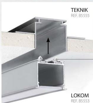
TEKNIK – profil techniczny przeznaczony do budowy precyzyjnych szczelin (wpuśców) w płaszczyznach ścian i sufitów kartonowo-gipsowych, dla osadzenia odpowiednich profili LED np. LOKOM, GIZA, GIP, LIPOD. Profil TEKNIK montuje się jednocześnie z konstrukcją ścian i sufitów kartonowo-gipsowych.
