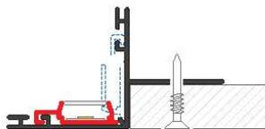
3. / Szttywne zamocowanie profilu ONISA umożliwia **sznur silikonowy (zawarty w komplecie)**. Dolna krawędź listwy TENI stanowi przedłużenie nisy i po zaszpachlowaniu tworzy cienką, estetyczną krawędź. Konstrukcja oprawy uwzględnia demontaż profilu świecącego, w celach serwisowych.
